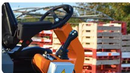
Afin d'avoir une concentration optimale sur le travail que l'opérateur effectue, l'ensemble du dispositif de conduite s'effectue à l'aide d'un joystick permettant de gérer les différents relevages (ventrale, arrière et contrôle de la sortie hydraulique annexe). Le Joystick contrôle également la commande d'avancement du porte outils. L'avancement est proportionnel à la poussée de l'opérateur. Le Culti'track est équipé de deux gammes de vitesse : lente (travail au champs) et rapide (déplacement).
